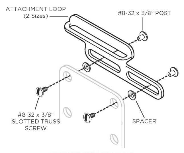
SCREW HEADS SHOULD BE POSITIONED ON THE FRONT SIDE OF THE SHEATH FOR QUICK ACCESS AND EASY ADJUSTMENT
